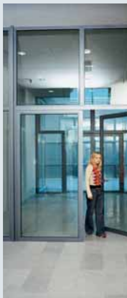
8 Tâmplărie din profile tubulare antifoc și etanșă la fum
